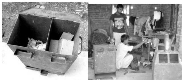
Fig.1. Montage du Mini-incinérateur (Mbog,2016).
